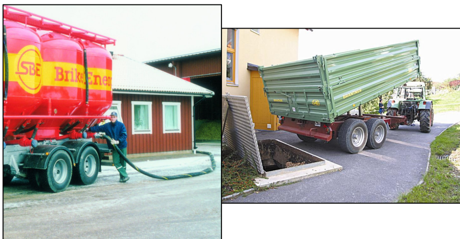
Rys. 10.5. Pelety są dostarczane do większych kotłowni za pomocą cysterny, lub wywrotki.
