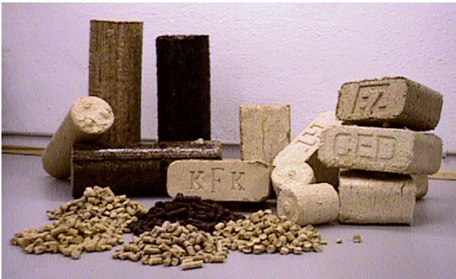
Rys. 4.1. Średnica pelet wynosi od 3 do 25 mm, w zależności od użytej matrycy. W przypadku większych wymiarów produkt jest określany mianem brykietu.
