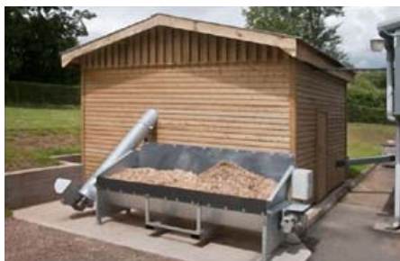
Rysunek 10. Połączenie podajników śrubowych
