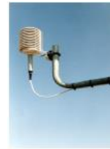
Pomiar temperatury i ciśnienia
